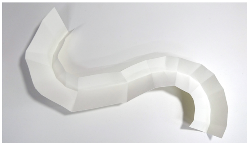
図 4.4: 図 4.5 左図の曲線折り形状をカッティングプロッタに入力して紙に出力したもの
