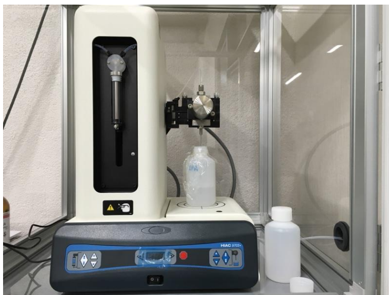
図 2.4 : パーティクルカウンタの機器本体
