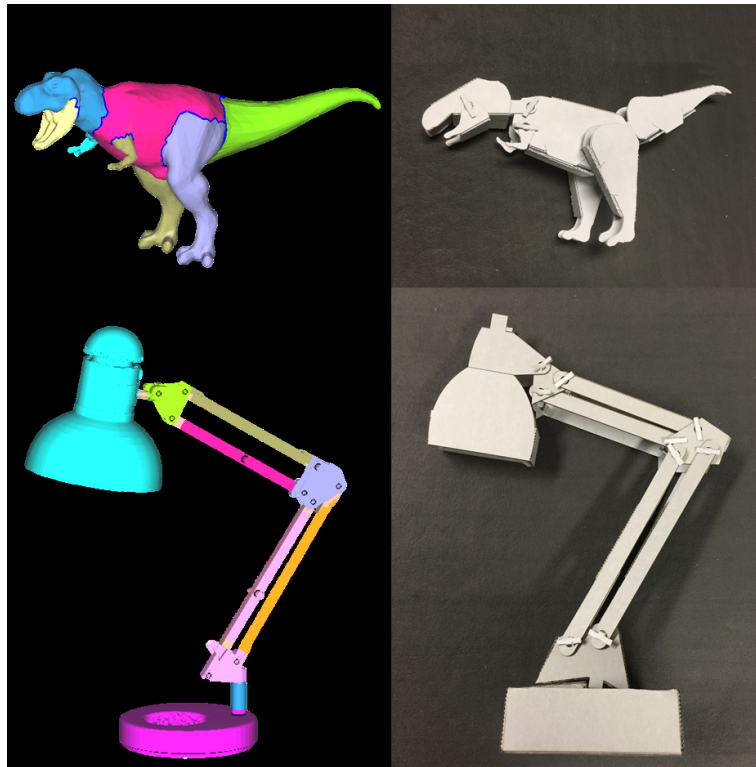
図 2.6: Zhang らの手法 [22] で生成される立体構造 (出典 [22])。左図は入力された立体モデルであり、右図は生成された部品を組み立てて制作された立体構造である。
