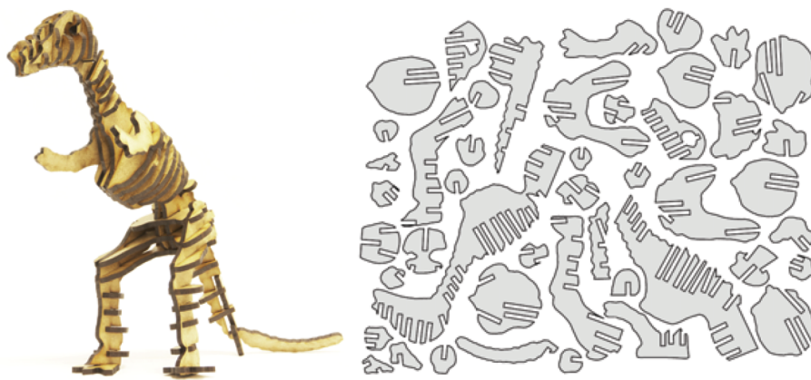
図 2.7: Schwartzburg らの手法 [23] で生成される立体構造 (出典 [23])。左図は生成された立体構造であり、右図は各部品の形状を表す。
