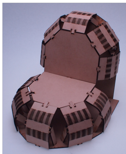
図 4.2: 固定部品のある立体構造の例。上段は椅子の座面部分である。下段では椅子全体を設計した (高さ 16cm)。
