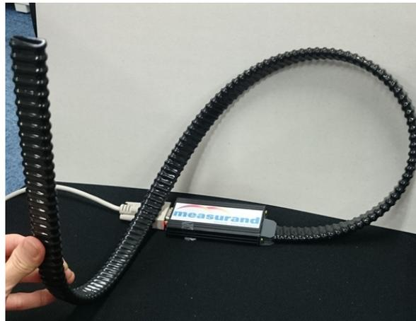
図 3.11: 最大振率 3.14 を出力した際の ShapeTape。
