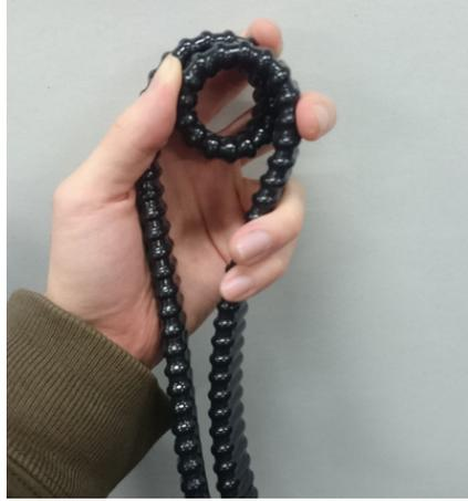
図 3.10: 最大曲率 0.65 を出力した際の ShapeTape。
