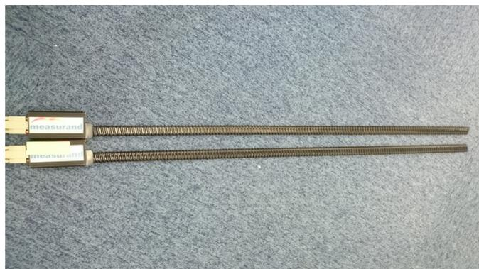
図 3.3: 床で校正している様子。平らならば机の上などでもよい。本研究では二本の ShapeTape を使う機能を使用することがあり、その場合の校正の様子を示している。
