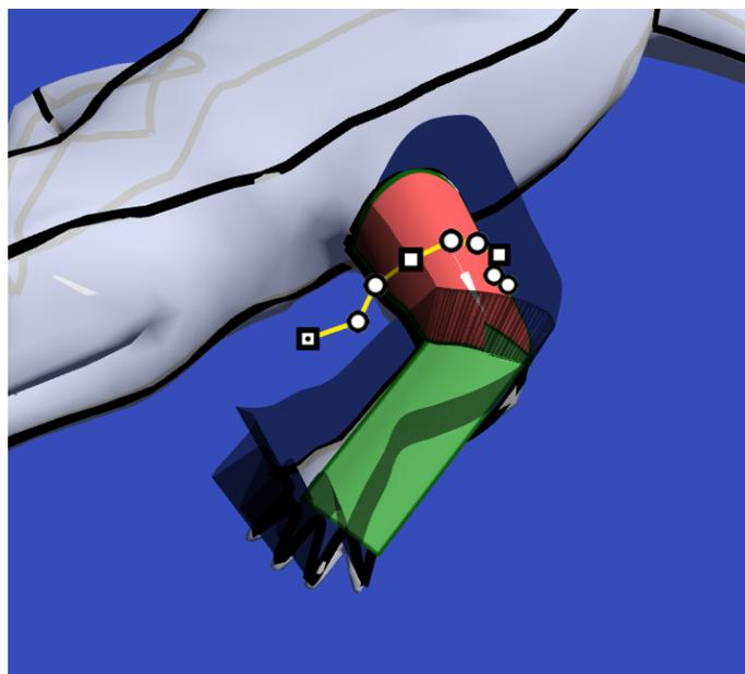
図 5.1: 可展面パッチの不適切な自動生成の例。新しく生成されたパッチ(緑)の大きさが十分ではないため、境界壁によるトリムを行うことができない。
