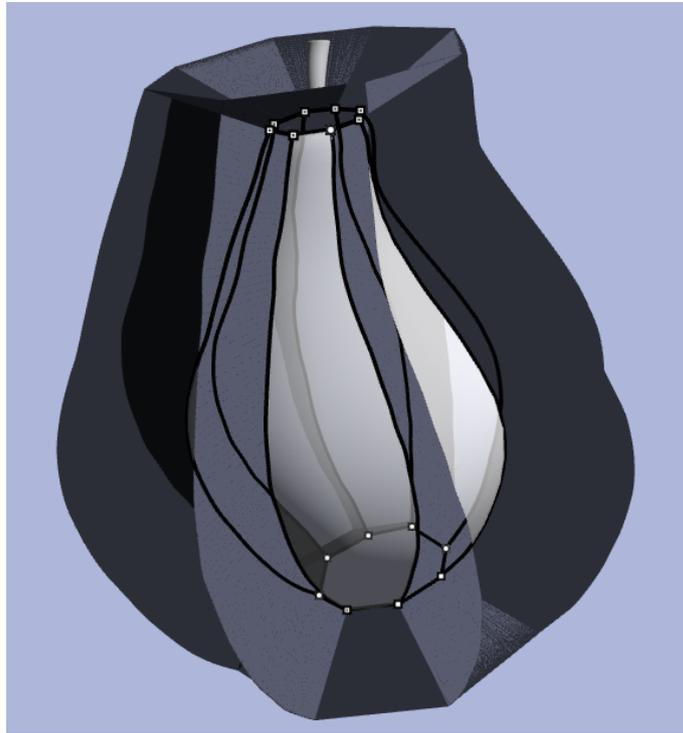
図 3.1: 提案システムで生成される境界壁の例。黒い曲面が境界壁を示す。リファレンスモデル上に配置された切開線を掃引することで境界壁が生成される。
