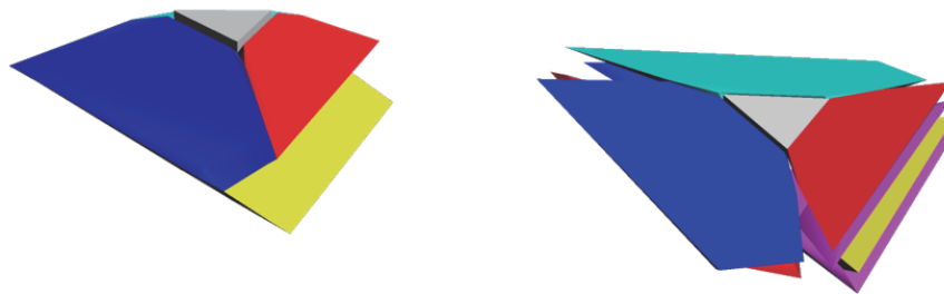
図 3.26: 1つの回転軸によるヒンジを用いた折りたたみモデル (左図は折りたたみ前の形状であり，右図は折りたたみ後の形状である.)
