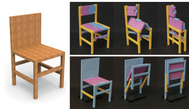
図 2.2: Li らの手法 [7] によって生成される折りたたみ可能な椅子 (引用: 参考文献 [7]) (左図は入力したモデルであり, 右図は自動生成されたそれぞれ折りたたまれる方向が違うモデルである.)
