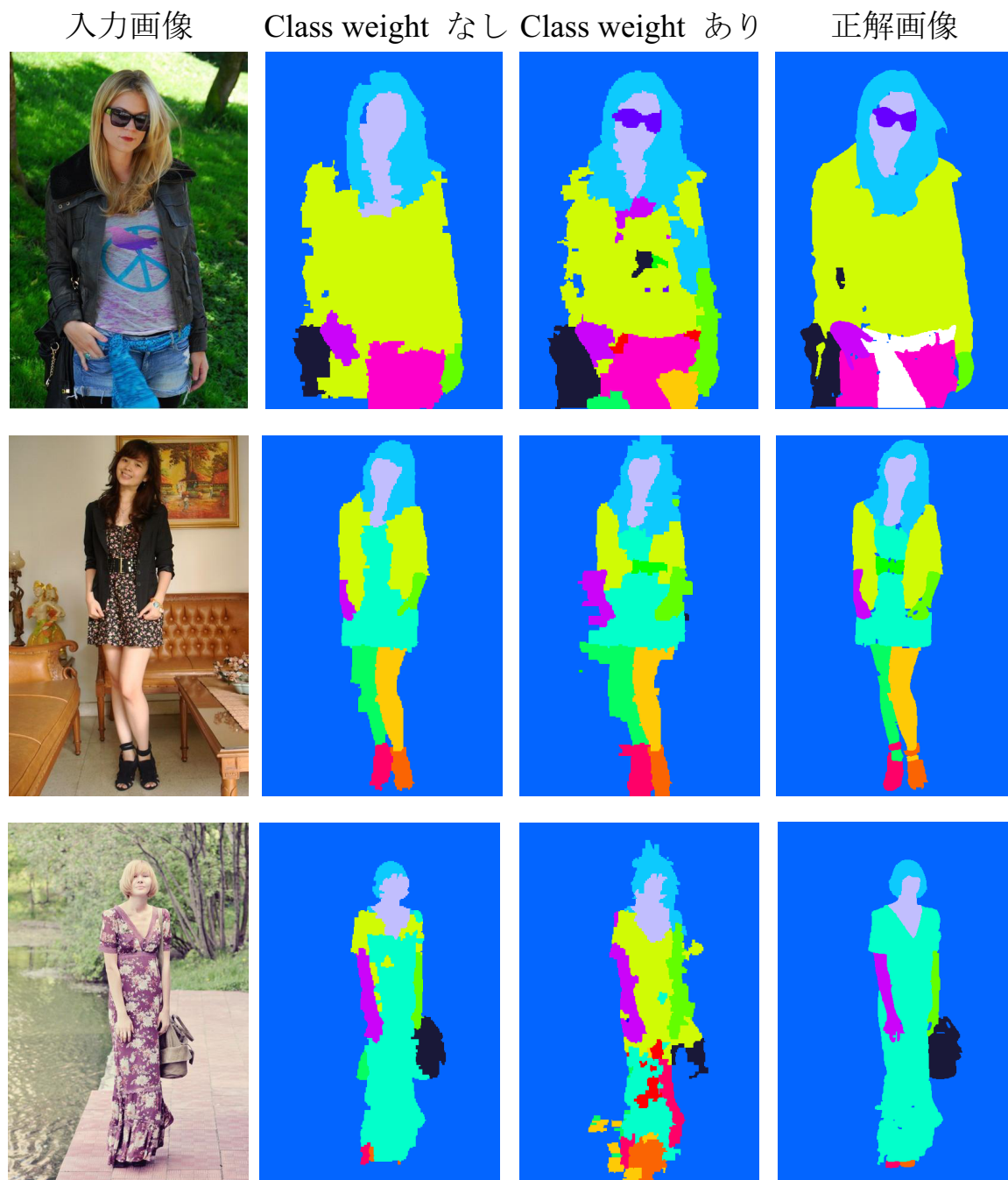
図 5.5: class weight の有無による結果画像の比較. 上段, 中段ではラベル総数の少ない glass や belt の領域が検出できている. しかし, ラベル総数の多いラベルは推定されにくくなり, 下段のように推定に失敗する場合もある.
